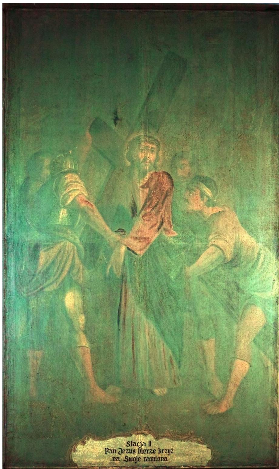
Fotografia 7 Fotografia w luminescencji wzbudzonej UV – widoczne warstwy wtórnego werniksu na powierzchni obrazu. Dodatkowo pociemniałe miejsca to przemalowania.
