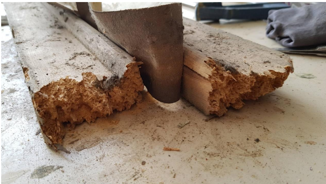
Fotografia 33 Przekrój przez krosna – widoczne zniszczenia na skutek działalności owadów. Na zdjęciu zwraca uwagę fragment krawędzi, doklejonej wtórnie, przy krawędzi obrazu.
